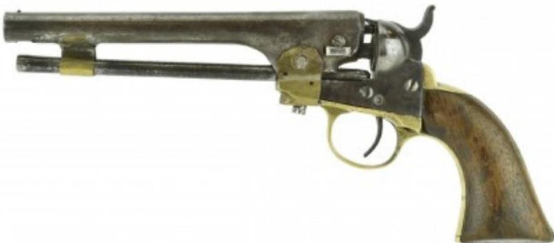
*Abb.4: Frontier-Conversion eines Revolvers COLT 1862 in eine einschüssige Vorderladerpistole unter Beibehaltung der vorhandenen Baugruppen Griffstück/ Rahmen und Waffenlauf unter Verzicht auf die Trommel*
